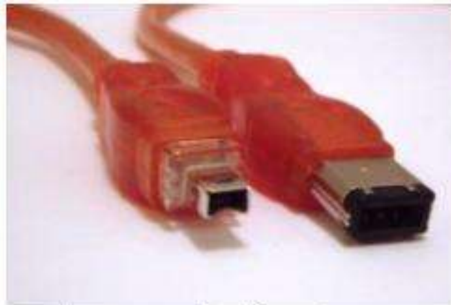
4-pinski (lijevo) i 6-pinski (dsno) FireWire konektori
