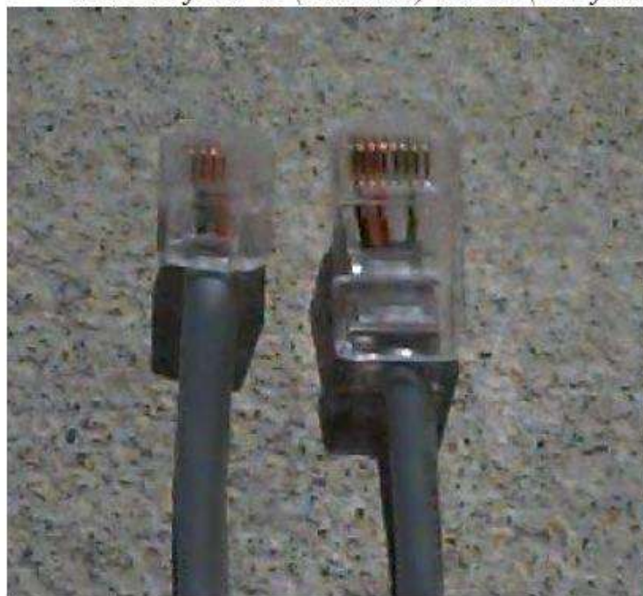
Poređenje RJ45 (Ethernet) i RJ11 (Telefonskog) konektora UTP sa 4 parice
